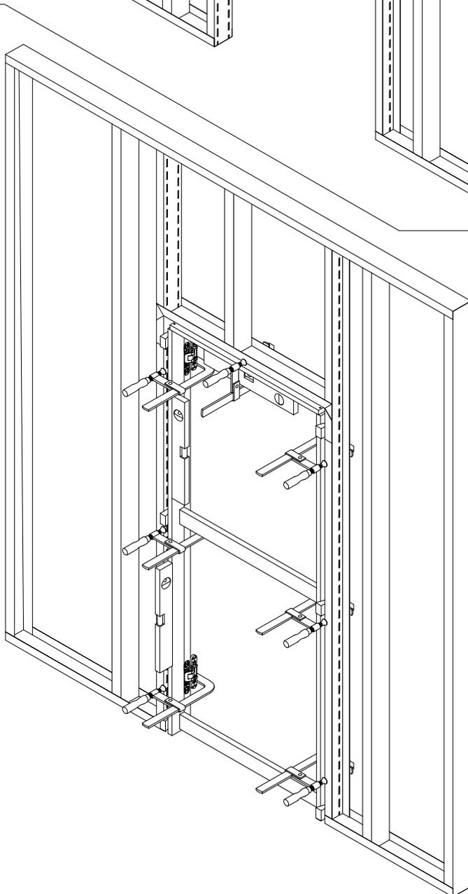
12. Ausbalancieren und Befestigen des Zargenrahmens in der Bauöffnung der unverdeckten GKB-Wand
